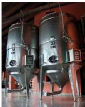
**Metodo Ganimede®** permette l'introduzione, attraverso una speciale valvola, dei gas tecnici direttamente nell'interstizio sotto il diaframma. In questo modo è possibile ottenere un'azione più efficace rispetto a quella ottenibile in un serbatoio tradizionale. Con **Metodo Ganimede®** le condizioni chimico-fisiche necessarie per un corretto discioglimento del gas nel liquido (pressione, superficie e tempo di contatto, temperatura) sono rispettate.
