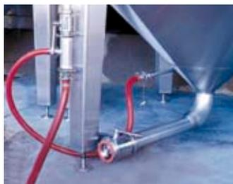
Fondo Conico con dispositivo "Sluice Point"
