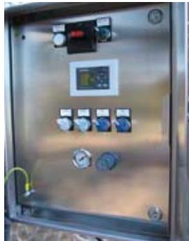
Este dispositivo resalta la gran versatilidad del Método Ganimede permitiendo la automatización de las distintas fases, que podrán ser programadas a discreción del enólogo para controlar las temperaturas, los ciclos de las aperturas de los bypass, la intervención de la sonda del nivel de seguridad y la temporización de la introducción de dos gases independientes ( $O_2$ ,  $CO_2$ ,  $N_2$ )
