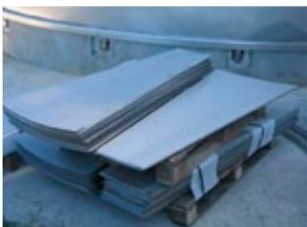
**3) Дольчатое строение диафрагмы:** доли диафрагмы предварительно изготавливаются в мастерской, по расчетам, сделанным на основе технического чертежа чана.
