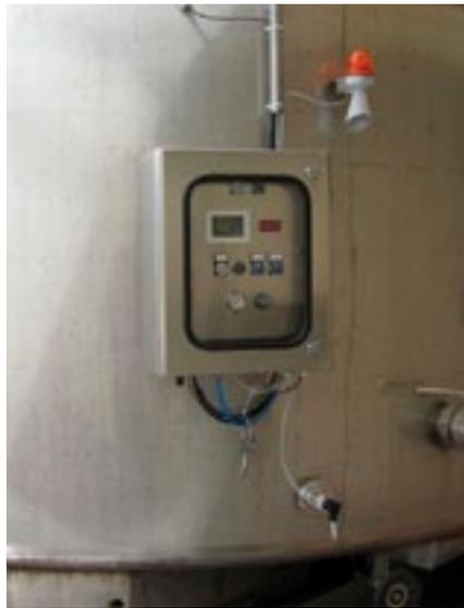
**6) Монтаж панели управления,** при помощи которой можно автоматически управлять температурой, открытием байпасов и впрыскиванием технических газов (макронасыщение кислородом, контроль  $\text{CO}_2$  для пленочной динамической мацерации перед брожением).
