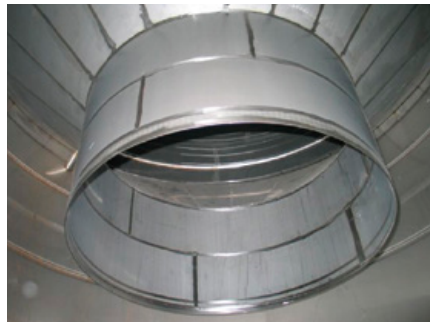
4) Soldadura interna de las porciones que forman el diafragma en forma de embudo: el diafragma “en forma de embudo” se recompone con un meticuloso trabajo de soldadura del que se encarga el personal especializado.
