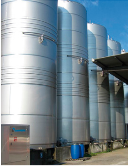
El trabajo concluye con la prueba hidráulica de ensayo del vinificador, con el fin de comprobar mediante simulación todas las fases que se afrontarán durante la vendimia.
