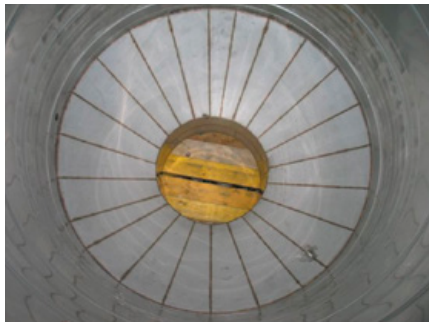
4) Soldadura interna de las porciones que forman el diafragma en forma de embudo: el diafragma “en forma de embudo” se recompone con un meticuloso trabajo de soldadura del que se encarga el personal especializado.
