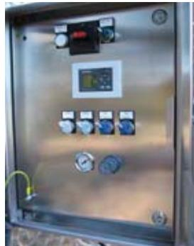
Ce dispositif souligne la grande polyvalence de la Méthode Ganimede en permettant l'automatisation des différentes phases; celles-ci pourront être sélectionnées selon la sensibilité de l'œnologue pour gérer le contrôle des températures, les cycles des ouvertures des by-pass, l'intervention de la sonde du niveau de sécurité, la temporisation de l'émission de deux gaz indépendants ( $O_2$ ,  $CO_2$ ,  $N_2$ ).
