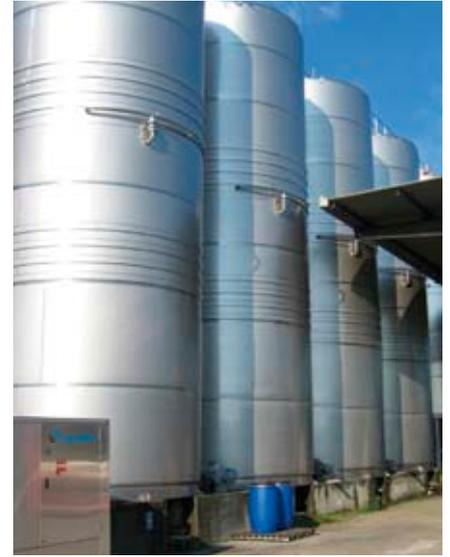
**Le travail se termine par le test hydraulique du vinificateur afin de contrôler par simulation toutes les phases qui seront affrontées durant la vendange.**
