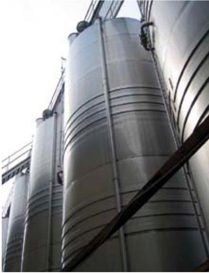
**5) Soudure de la chambre de refroidissement sur le revêtement externe:** si cela est nécessaire, la cuve est soumise à un traitement thermique avec l'application de chambres en buse ou en enveloppe qui sont soudées sur le cylindre de la cuve.
