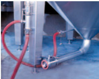
Konischer Boden mit "Sluice Point" Vorrichtung
