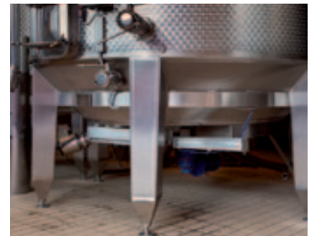
Boden mit mechanischer Tresterextraktion
