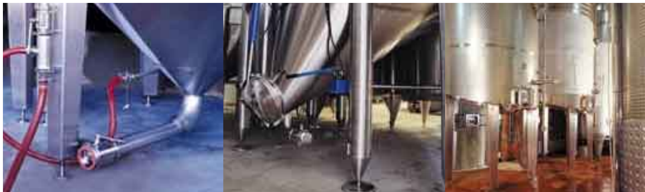
Fondo Conico con dispositivo Sluice Point
